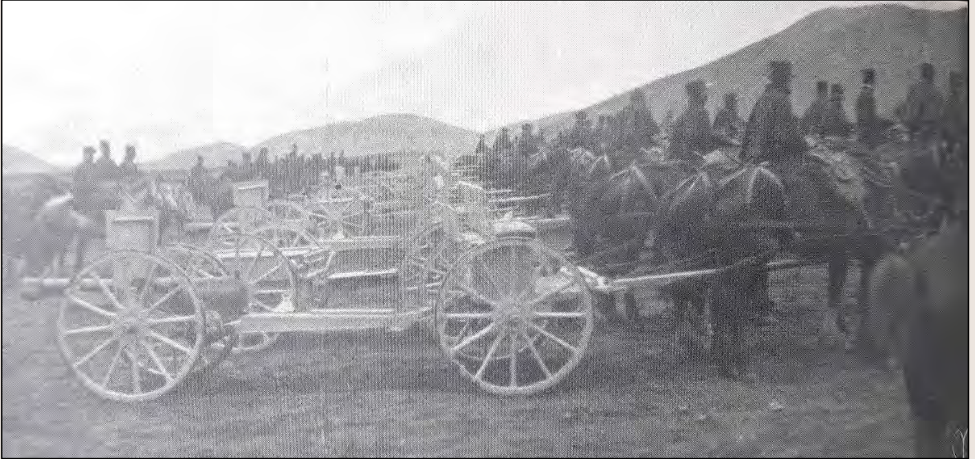
FIGURA 8. Cañones de campaña Schneider-Canet de 75 mm de tiro rápido, en posición de transporte con su avantrén y sus caballos, al costado de cada pieza se puede ver su carro municionero con avantrén y armón durante una revista en las afueras de Lima en 1908. Foto, revista Varietades 1908.
