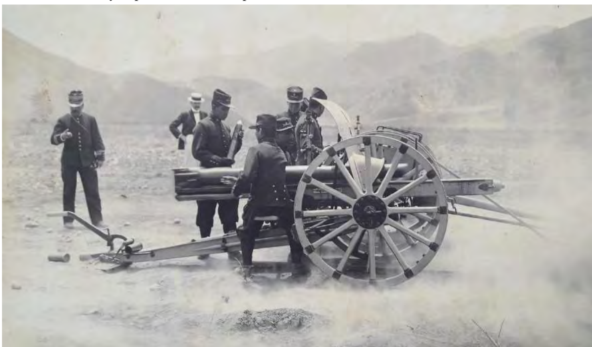
FIGURA 5. Cañón de campaña de tiro rápido Krupp de 70 mm, durante los ejercicios de tiro llevados a cabo en 1905 en el polígono de tiro de Cascajal en los terrenos de la hacienda Monterrico Chico (aproximadamente en el cruce de las avenidas Primavera y Encalada en Surco). Foto, Memoria de la Comisión Examinadora de cañones de campaña (1905).
