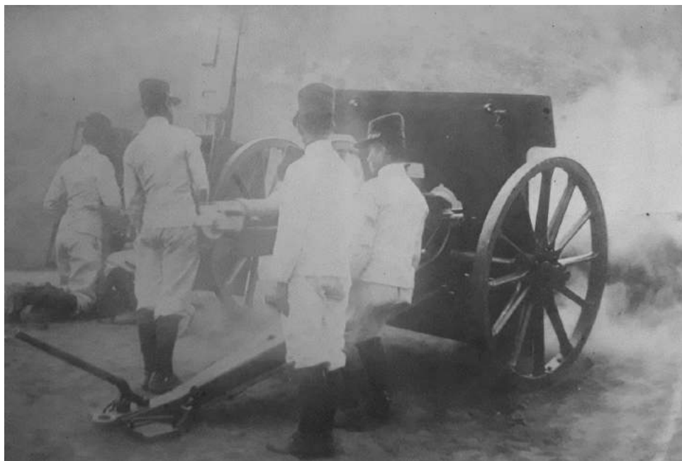
FIGURA 1. Pieza de campaña Schneider-Canet TR LD modelo 1904 disparando en el polígono de tiro de la pampa del Cascajal (hacienda Monterrico Chico) en abril de 1905 durante las pruebas de selección del material de artillería de campaña. Foto, Memoria de la Comisión Examinadora de cañones de campaña (1905).
