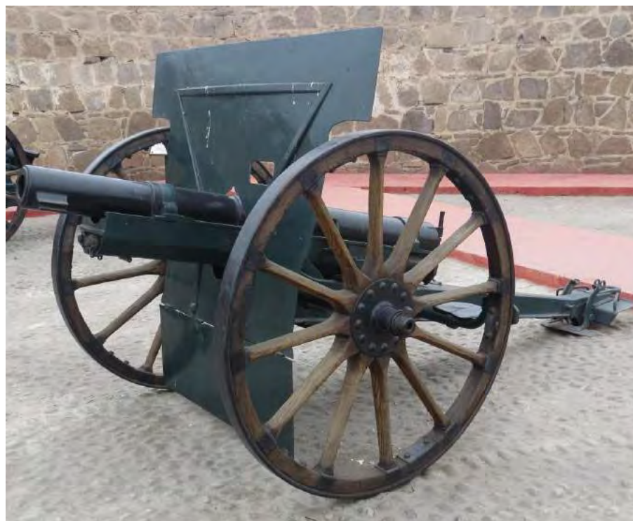
FIGURA 7. Vista frontal del cañón de artillería de campaña Schneider-Canet TR LD calibre 75 mm, preservado en el Museo del Ejército de la fortaleza del Real Felipe . Foto, el autor.
