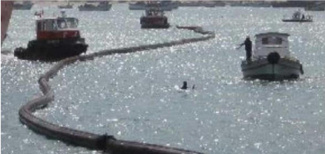
**FIGURA 5.** Barreras flotantes de contención de petróleo
