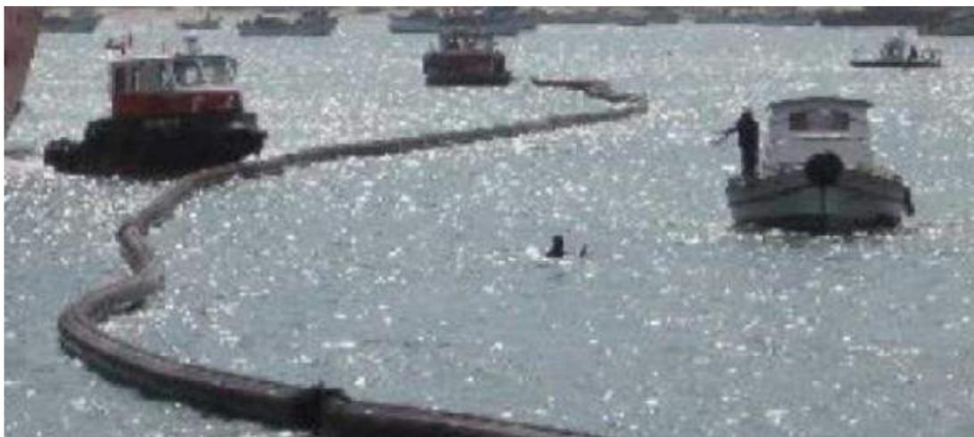
**Figura 5.** Barreras flotantes de contención de petróleo
